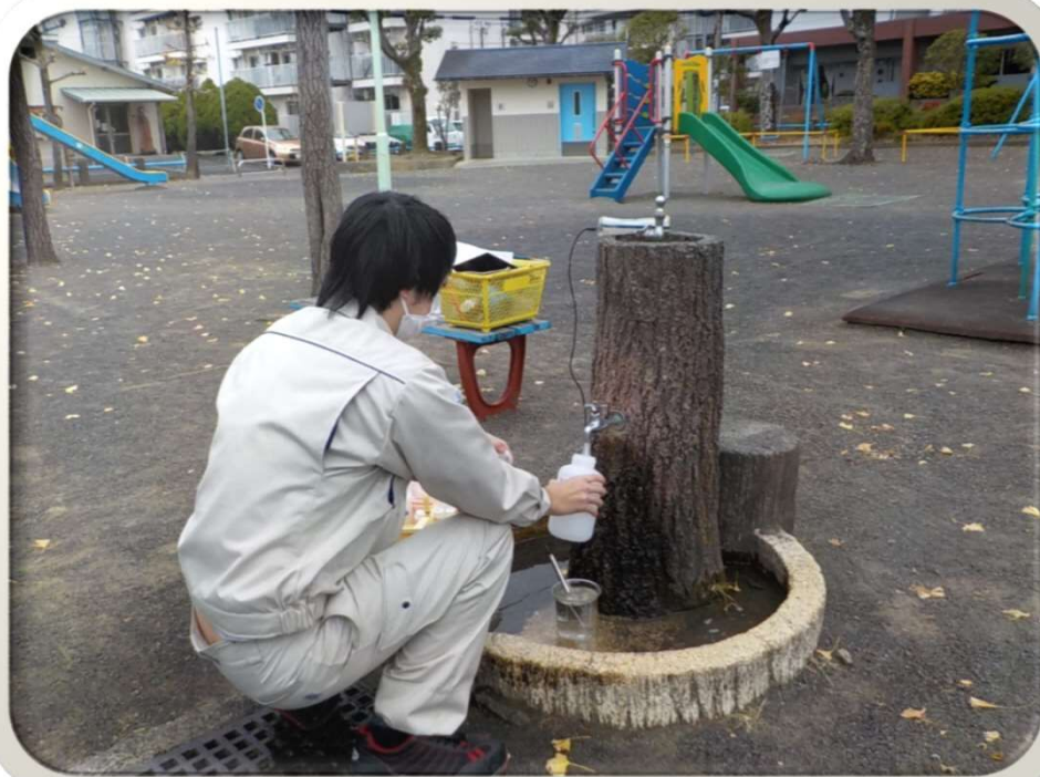
水道水の検査 (給水管末での試料採取)
