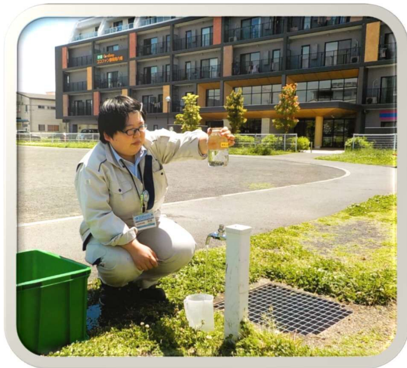
水道水の検査 (給水管末での試料採取)
